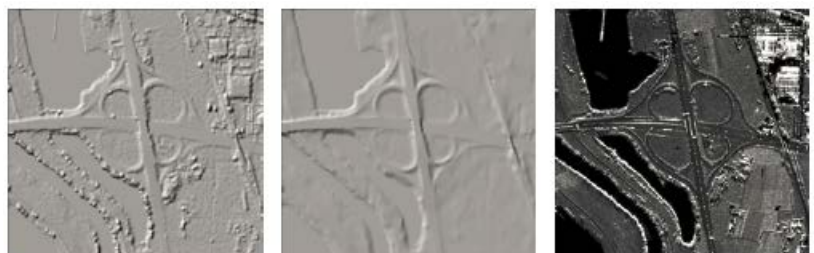
図 1-13 IFSAR を用いた DEM 作成、（左）DSM、（中）DTM、（右）オルソ化画像（出典：INTERMAP 社）
