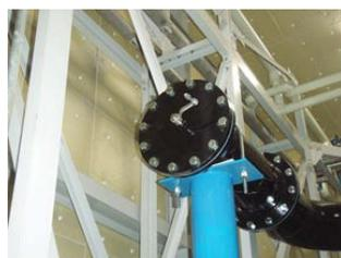
端部には長さ微調整機構 (ピストンのハンドルが見えている)
