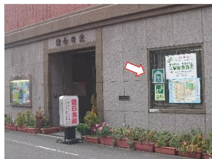
本パネルは、図表 1-(2)-⑬に記載した事例にある内照式〔簡易ソーラーパネル式〕のものと同じタイプのもので、標識看板内部のソーラーパネルで発電し、夜間、LED ライトを光源に内照式で表示面全面を発光させている。次写真にあるとおり、電気配線工事を必要とせず、容易に柵に設置することが可能である。
