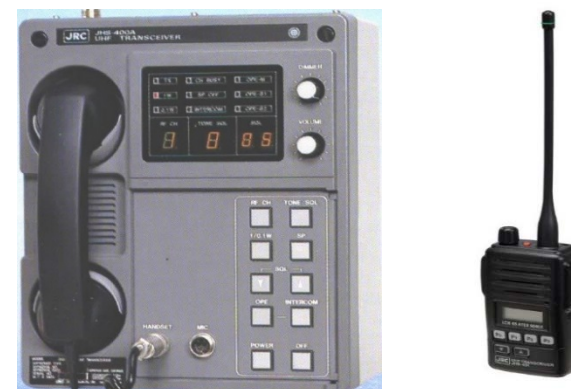
船上通信設備の無線機の例
