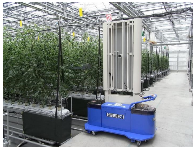
生育診断ロボットによる光合成機能診断 →害虫発生状況との関係
