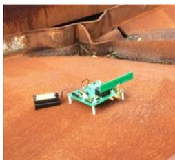
図 9 ダイポールアンテナを取り付けた通信 LSI
