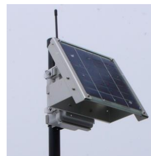
図 1 新型中継機 従来に比べ、体積・重量ともに約半分。アンテナを上部に位置させ、設置を容易化
