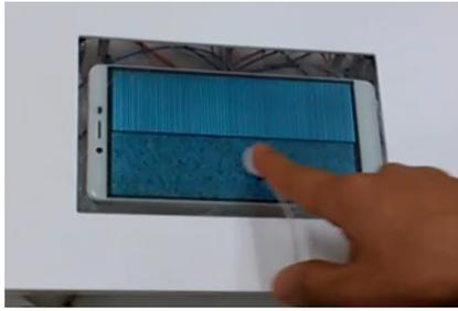
図 2 機械的変位刺激と静電気摩擦刺激を併用したタッチパネル用の触感ディスプレイ（試作機）
