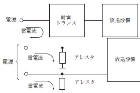
(エ) 制御に使用する電気通信回線からの雷対策として、サージ吸収素子を取り付ける措置
