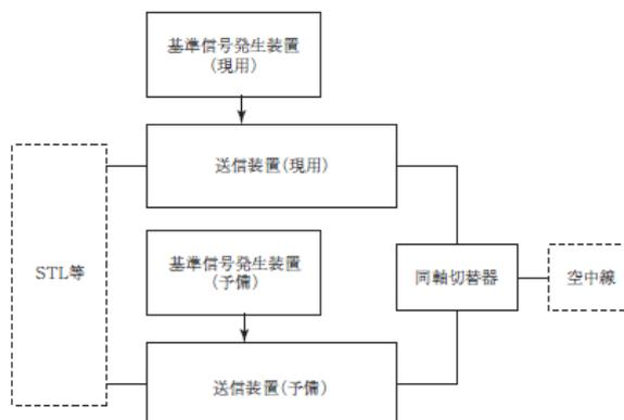
(イ) 送信装置を並列合成方式とする措置（第3図参照）
