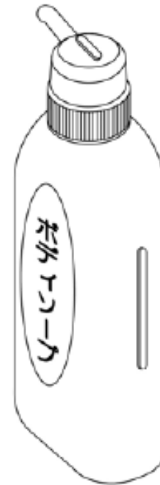
図 C.1.3—容器に触覚記号を付加 身体用（顔用及び頭髪を除く）洗浄料
