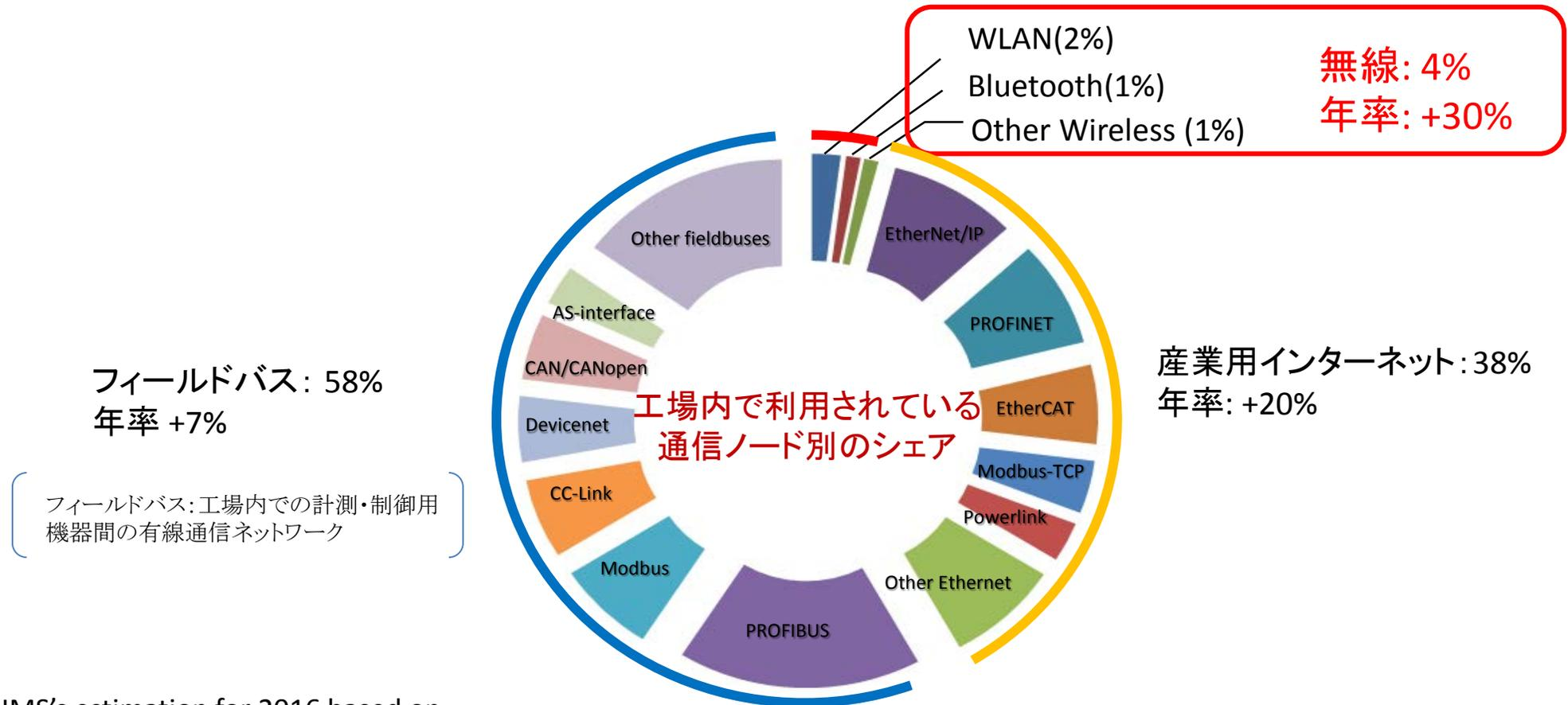
フィールドバス: 工場内での計測・制御用機器間の有線通信ネットワーク
