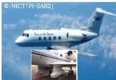
※<sup>1</sup> 合成開口レーダー（SAR:Synthetic Aperture Radar）：地上に向けて電波を発射し、その反射波を受信側の合成開口の信号処理技術を用いて対象物を高い分解能で取得可能なレーダー。
