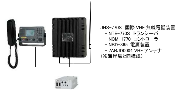
図 6.1-4 装置構成(仮想船舶局)
