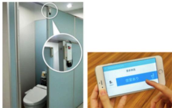
トイレのドアに取り付けたセンサーによってドアの開閉を検知し、送信された情報をアプリケーション側に連携して、トイレの空き状況を視覚化しています。
