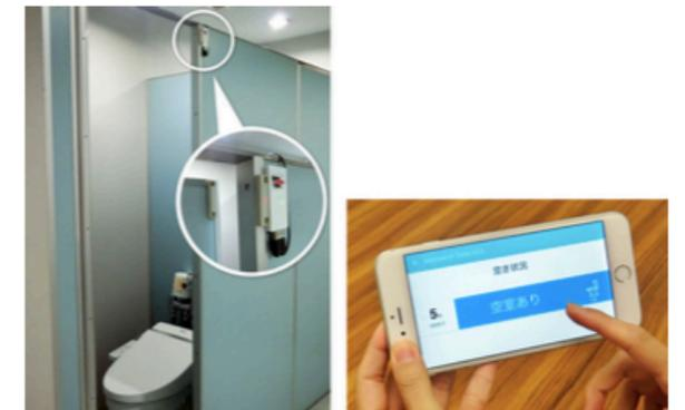
トイレのドアに取り付けたセンサーによってドアの開閉を検知し、送信された情報をアプリケーション側に連携して、トイレの空き状況を視覚化しています。商業施設やテーマパークなどでのトイレの混雑緩和を目的とした活用が考えられるほか、防犯や介護事業などへの応用も期待できます。
