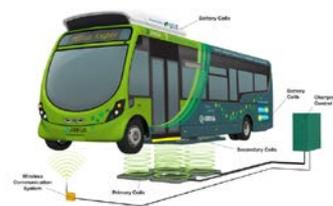
バスへの電力伝送では100kW以上となるため大きな磁界に晒される可能性。
