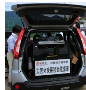
北陸総合通信局所有の災害対策用移動電源車により放送機材への電源供給を行った
