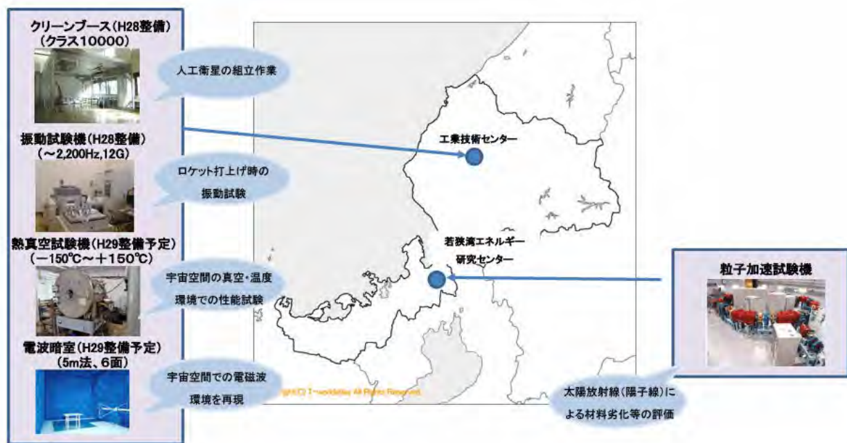
図 2.1-1 福井県における小型衛星環境試験設備
