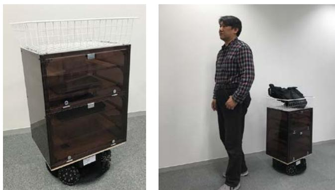
図 5 試作した自律型モビリティ（運搬ロボット）
