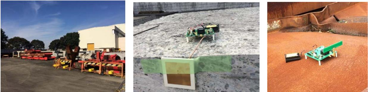
図 3-12 （左）臨床研究用撤去部材保管施設（中）パッチアンテナを取り付けた通信 LSI（右）ダイポールアンテナを取り付けた通信 LSI
