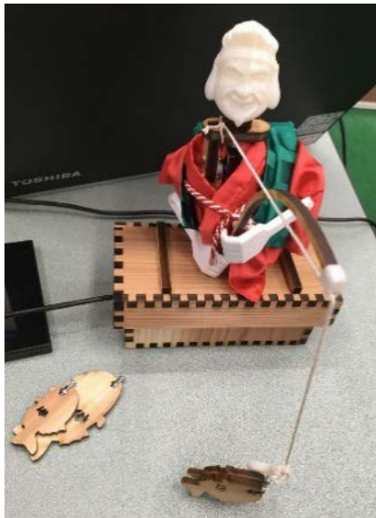
頭や手は3Dプリンタで、竿や台等は地元の杉材をレーザーカッターで加工
