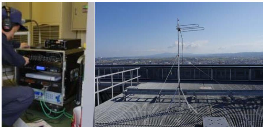
北陸総合通信局所有の臨時災害放送局用機材の本体部（写真左）とアンテナ部（写真右）。災害時又は訓練時に地方公共団体への貸出しが可能。最大出力は100ワット<石川県庁>
