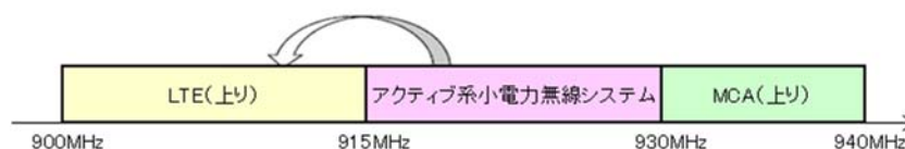
参図 3 - 10 アクティブ小電力無線システムから携帯電話システム（LTE）上りへの影響
