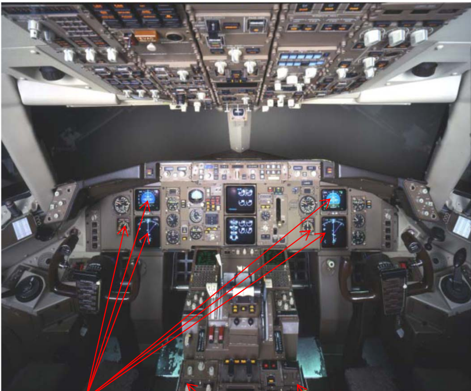
コックピット内の無線設備配置例
