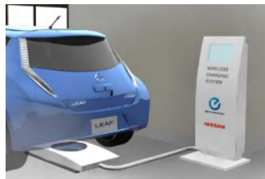
電気自動車への給電
