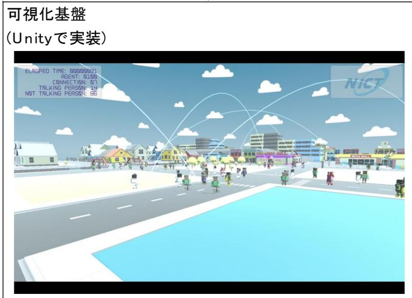
StarBEDの実機を用いたICT環境を構築。シミュレータで通信開始のイベントが発生するとそれに応じたデータを実際にICT環境上に送出、リアルなトラフィックが発生。輻輳等での通信失敗等の情報をシミュレータ側にフィードバックし、シミュレータ内の挙動にも実環境のイベント情報を反映。
