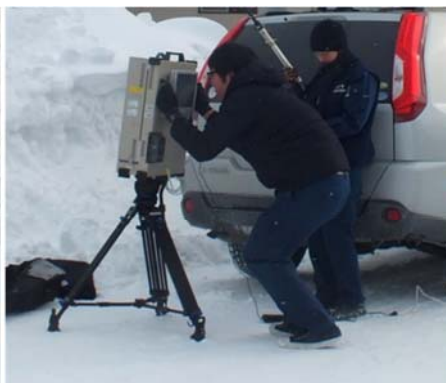
電波発射源可視化装置による探査
