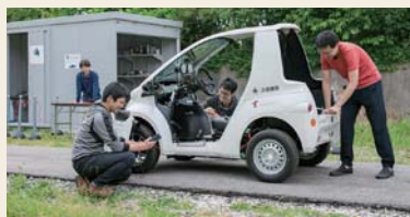
▲世界初！バッテリーレスな電気自動車の有人走行
