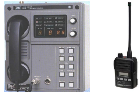
船上通信設備の無線機の例
