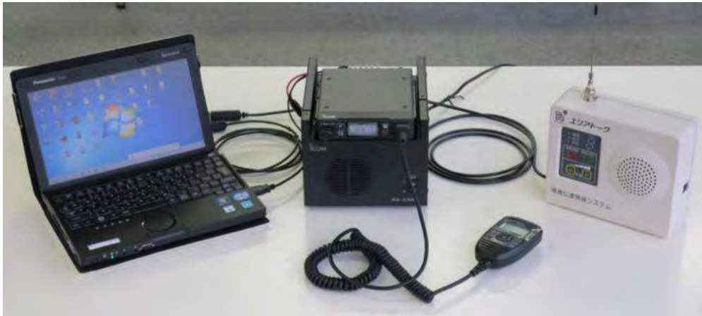
付図 16 戸別受信機のシステム構成
