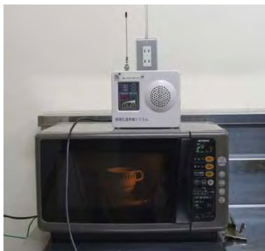
図 2-51 電子レンジ上でのノイズ測定状況
