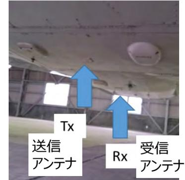
図：電波高度計アンテナ設置例
