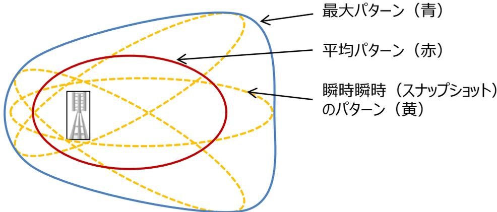
ビームフォーミングアンテナによる干渉電力の変動を考慮するため、以下の方法で統計データを取得し、空中線の指向特性をモデル化
