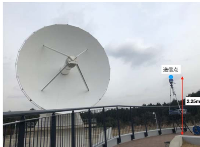
写真 5-4 石岡局測定点 A において送信アンテナをかさ上げた様子
