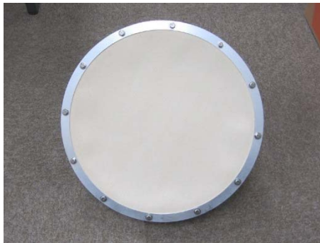
23GHz帯無線伝送システム試験評価器 0.3mφパラボラアンテナ
