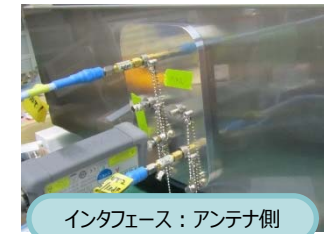
23GHz帯無線伝送システム試験評価器（フィールド試験器）
