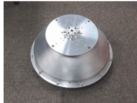
23GHz帯無線伝送システム試験評価器 0.3mφパラボラアンテナ
