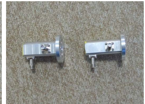
23GHz帯無線伝送システム試験評価器 偏波分離器（OMT）
