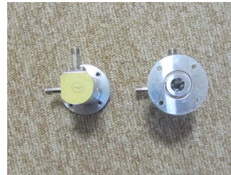
23GHz帯無線伝送システム試験評価器 偏波分離器（OMT）
