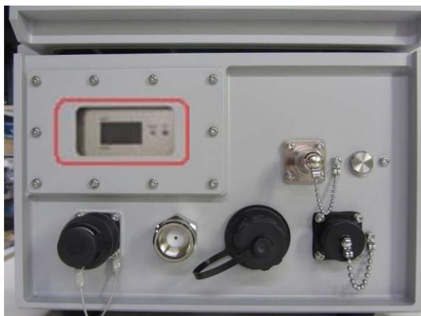
図 4-56 現行無線装置のインジケータ
