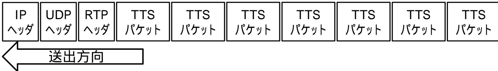
・タイムスタンプ付きTS(Transport Stream)パケット(TTSパケット)のデータ構造
