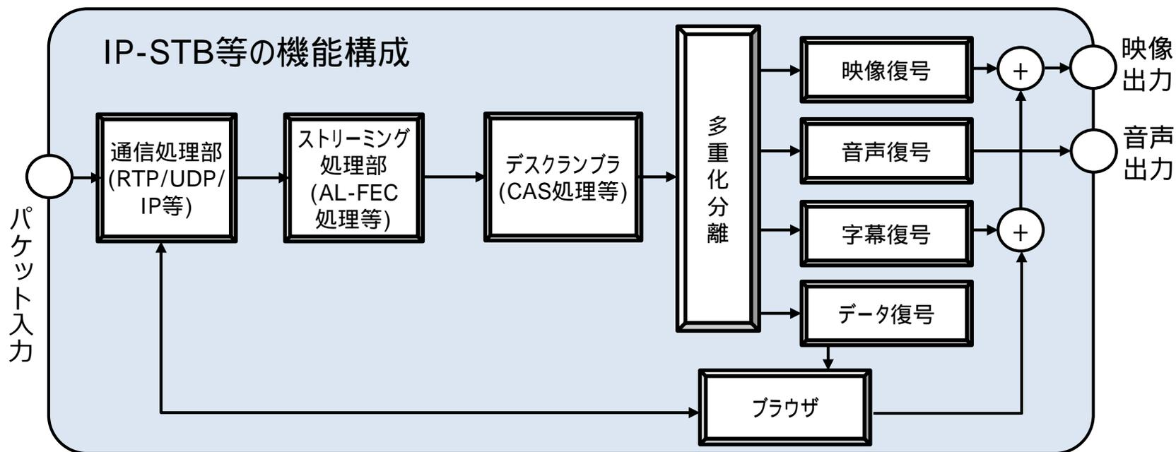
ヘッドエンドから受信者端子までの間でパケットの損失が生じた際に、その損失に対処する手段として、AL-FEC(Application Layer Forward Error Correction)がある。AL-FECについては、技術基準とはせず、利用するか否かは事業者の判断となるが、パケットの損失率の技術基準への適合性を評価する際に考慮する。
