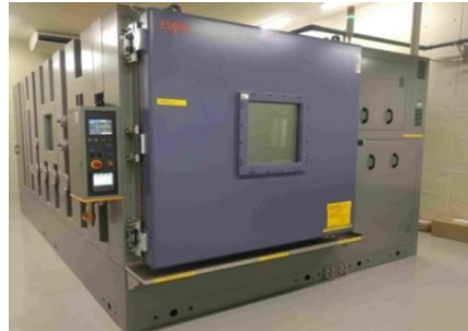
産業振興と人材育成の拠点 及び 同拠点に整備された環境試験設備（着氷試験設備）
