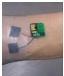
65nm CMOSで $53\mu\text{W}@0.19\text{V}$ 動作&温度センシングを達成
