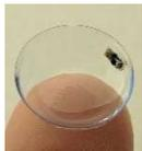
55nm CMOSで **$1.9\text{nW}@0.31\text{V}$** 動作を達成
