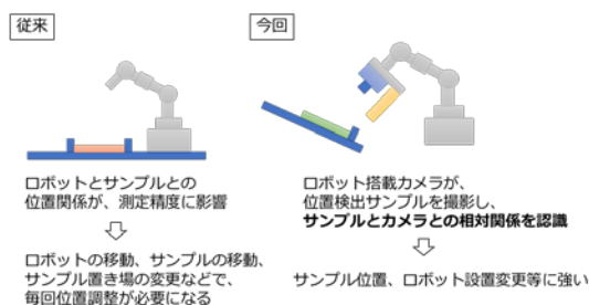
図3. ロボットとサンプルとの位置関係の調整方法の違い
