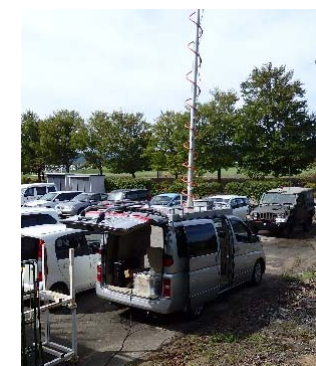
送信アンテナを設置した車両
