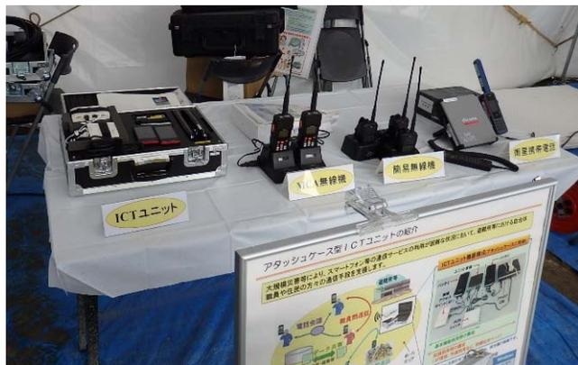
災害対策用移動通信機器の展示（左からICTユニット、MCA無線機、簡易無線機、衛星携帯電話）
