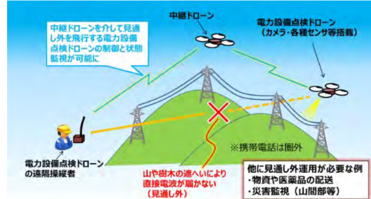
③ レイテンシ保証型ワイヤレス通信システムの見通し外電力設備点検応用
