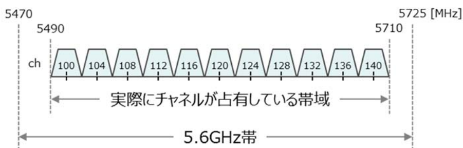
図2. 6. 1 5. 6GHz帯のチャンネル配置
