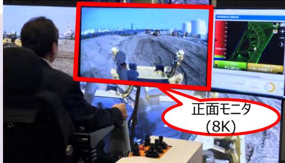
建築機械を低遅延で遠隔操作。トラクタ等への応用が可能。
