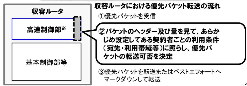
※ 收容ルータは、高速制御部と基本制御部等から構成されている。高速制御部では、各種サービスの契約の有無を設定情報として保持し、
