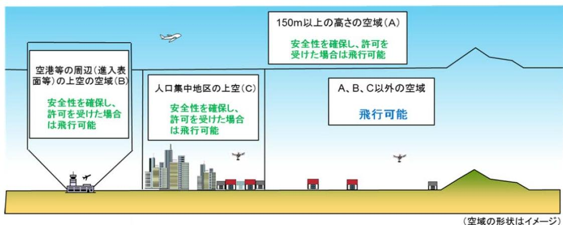
図 5.1 航空法によりドローンの飛行が制限されている高さ空域<sup>※5</sup>
