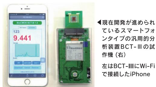
▲現在開発が進められているスマートフォンタイプの汎用的分析装置BCT-IIIの試作機 (右)
