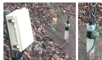
▲土砂水分量センサーシステム
