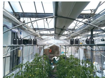
▲無線散乱光マルチセンサノードの施設内での評価用設置例
