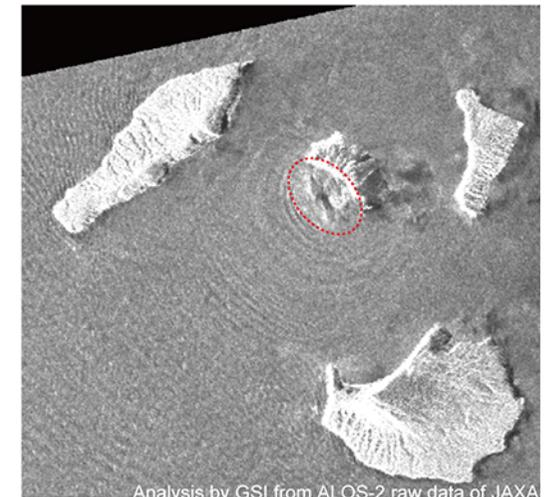
SAR強度画像の比較から、クラカタウ火山(Anak・クラカタウ)の山体の南西部で明瞭な地形変化が認められる。12月24日17時頃(UTC)までに2km四方にわたって島の南西部が崩壊したと考えられる。SAR干渉解析の結果、ヴェルラテン島とクラカタウ島で、Anak・クラカタウ島付近を中心として衛星から遠ざかる変動が見られる。
