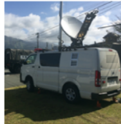
図 4.3 携帯電話基地局に関する緊急点検結果を踏まえた車載型基地局等の増設
