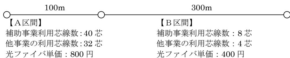
$$\bullet A\text{区間補助対象経費} = \frac{40\text{芯}}{40\text{芯}+32\text{芯}} \times 100\text{m} \times 800\text{円} = 44,444\text{円}$$
