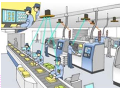
送信機：5~10m間隔に設置、4~16出力切り替え 受信機：5~10個/1送信機
