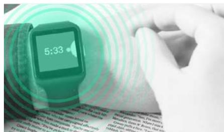
反射されるレーダー波（60GHz帯）を用いてユーザーの手の動きを認識してスマートウォッチ上の画面をスクロール
